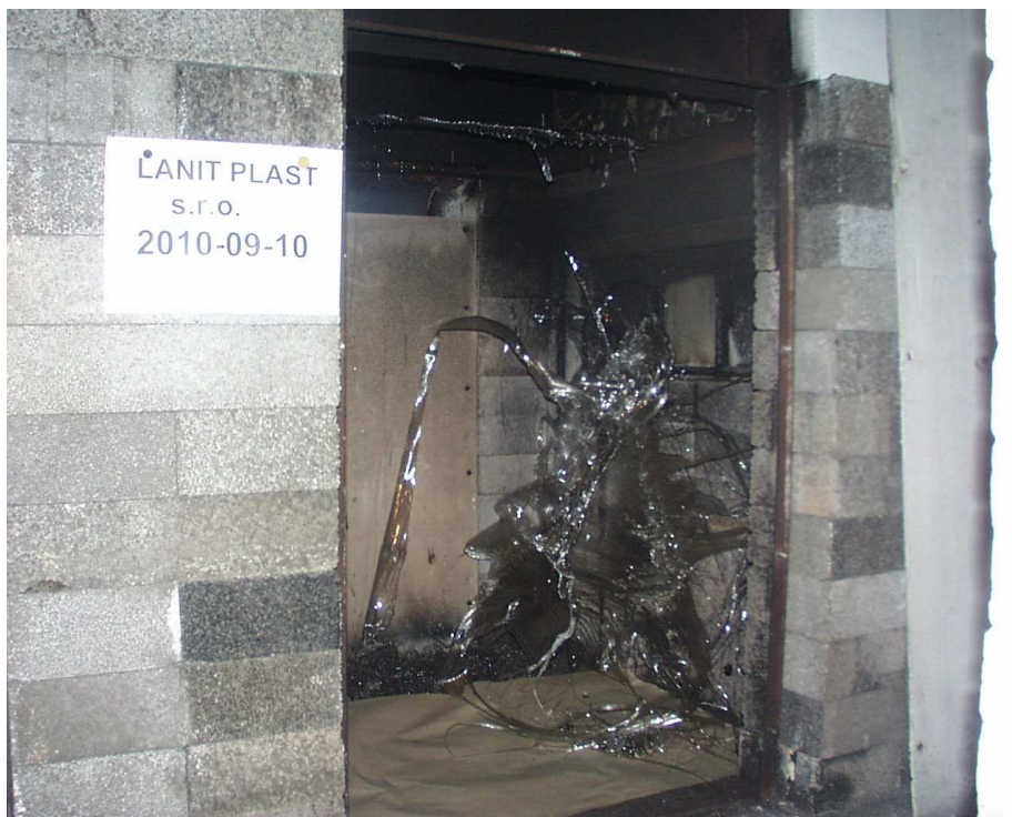
Pohled na zkušební vzorek č. 1 po zkoušce
